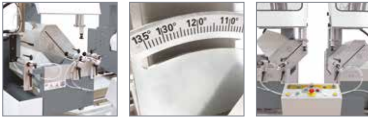
Troncatrice con lama a scomparsa a doppia testa con una unità fissa a sinistra ed una mobile. Double mitre saw with a fixed unit on the left and the other one movable.
